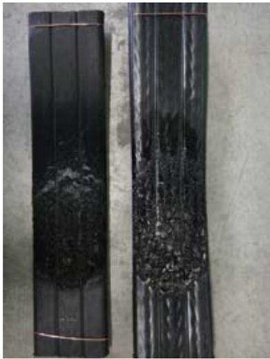
図5 JIS C3005 燃焼試験結果
